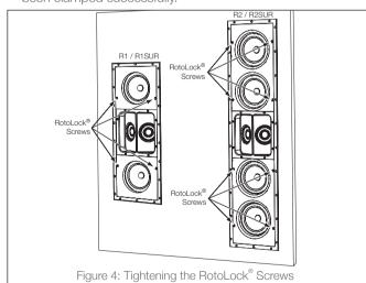
IMPORTANT: ALWAYS USE LOW-TORQUE SETTINGS; NEVER OVER TIGHTEN. NOTE: ADJUSTING THE TENSION OF THE ROTOLOCK® CLAMPS SO THAT THE SPEAKER FRAME IS FLAT WILL HELP ENSURE THAT THE GRILLE CONTACTS THE WALL ALL THE WAY AROUND THE SPEAKER FOR A PROPER FIT.
